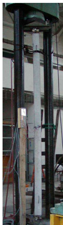
Obr. 1.: Geometria, vystuženie a uloženie stĺpa. Umiestnenie referenčného stĺpa v lise pri skúške
