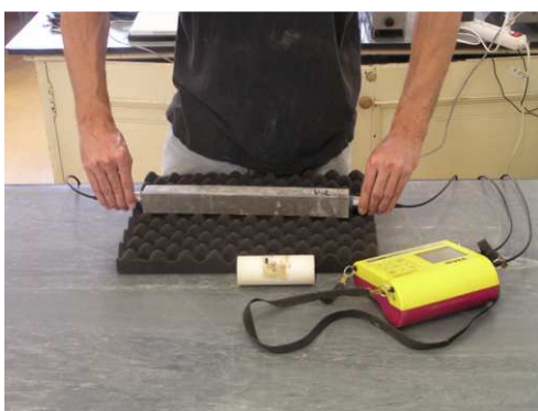
Obr. 2.: Měření modulu pružnosti ultrazvukovou metodou
