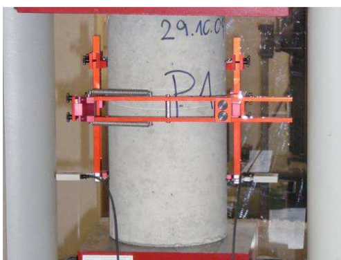
Obr. 8.: Měření modulu pružnosti v lisu FormTest
