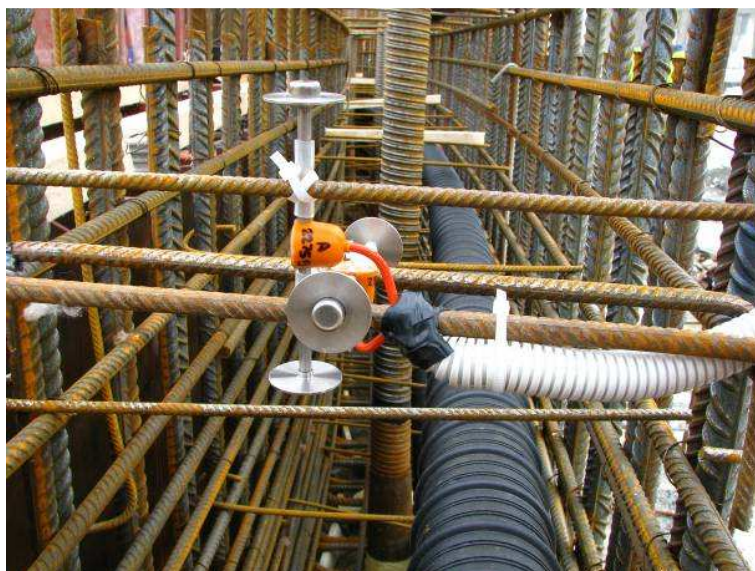
Obr. 4.: Umístění tenzometrů S1 a S2 v armokoši stěny
