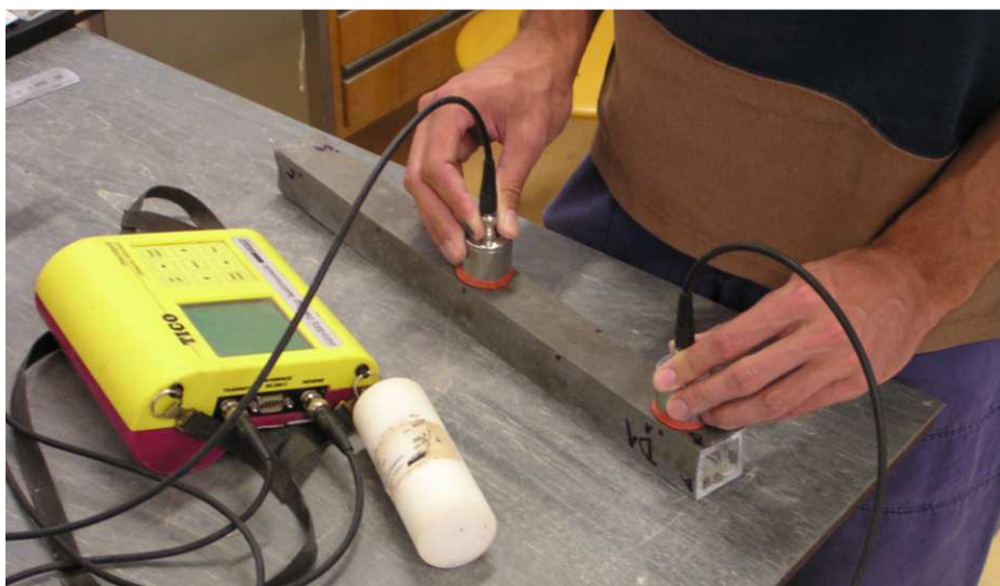
Obr. 4.: Povrchové prozvučování ultrazvukovou impulsní metodou
