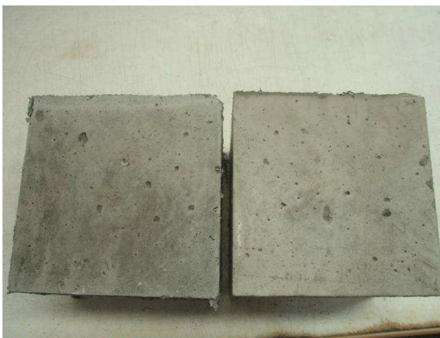
Obr. 2.: Pohled na krychle, vlevo nezakrytá, vpravo zakrytá víkem, na levé je patrný pruh u povrchu způsobený vyschnutím
