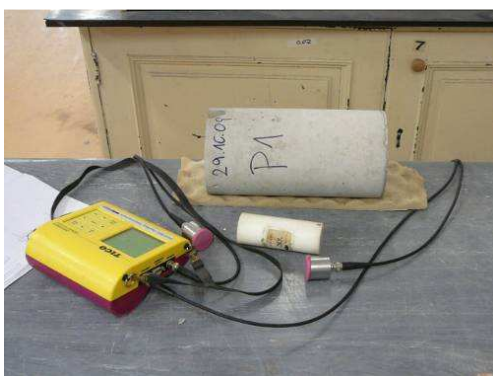
Obr. 6.: Měření modulu pružnosti ultrazvukovou metodou
