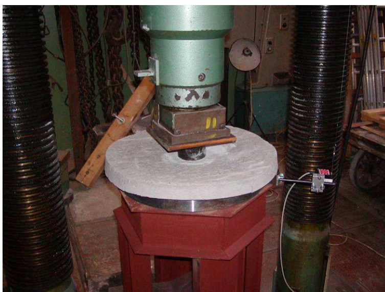
Obr. 2.: Uspořádání zkoušky kruhové desky o průměru 500 mm.
