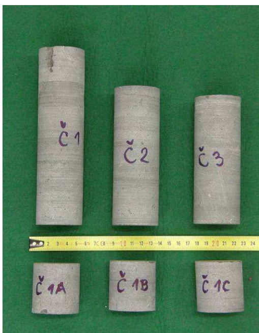
Obr. 2.: Vzorky čediče připravené ke zkoušce.
