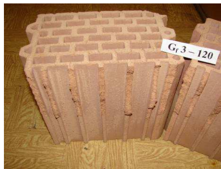
Obr. 6, 7.: Zkouška lomové energie (vrub 120 mm); lom bloku po zkoušce
