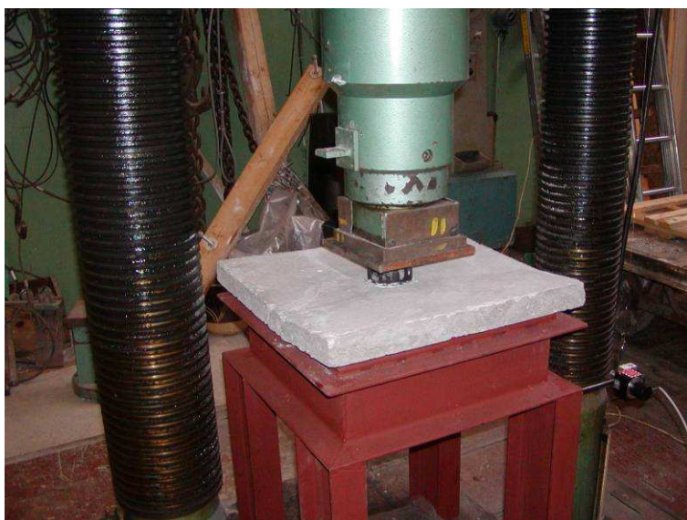
Obr. 1.: Uspořádání zkoušky čtvercové desky o straně 500 mm.
