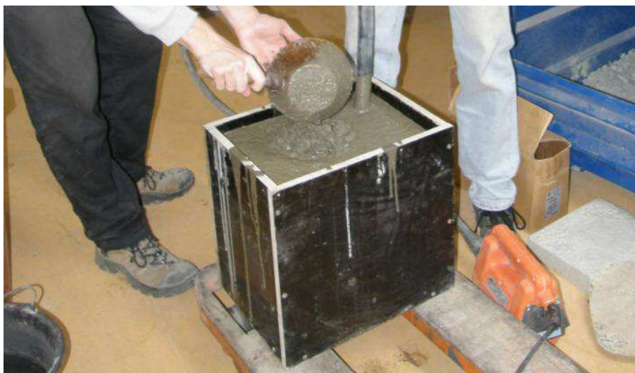
Obr. 1.: Výroba kvádrů určeného k odebrání jádrových vývrtů
