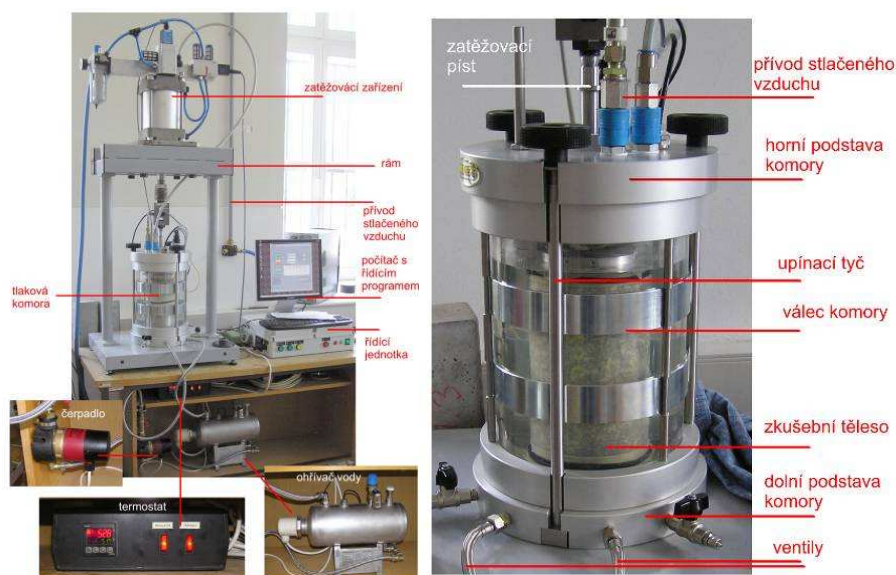
Obr. 9.: Dynamický triaxiální zatěžovací systém v silniční laboratoři VUT v Brně
