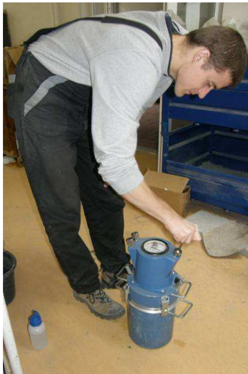
Obr. 4.: Zjišťování procent. množství vzduchu v čerstvém betonu
