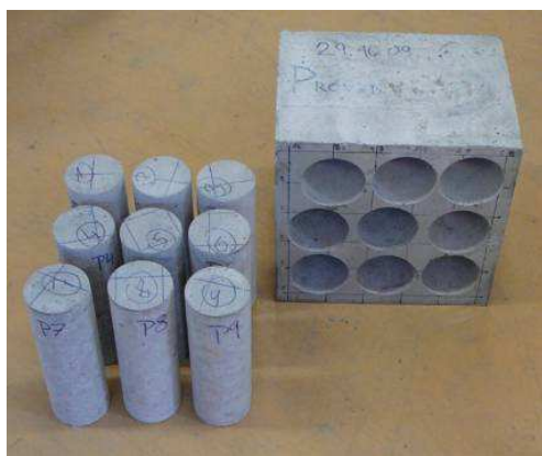
Obr. 5.: Z betonového kvádru byla jádrovým vrtáním odebrána válcová zkušební tělesa; vlevo provzdušněný beton, vpravo neprovzdušněný beton
