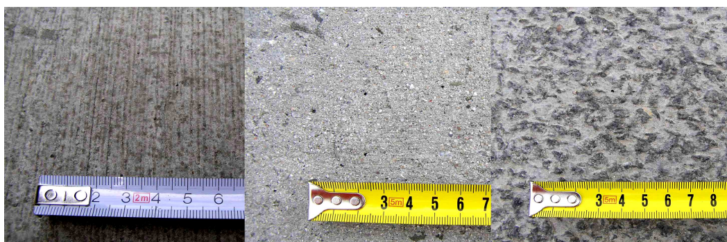
Obr. 5.: Úpravy povrchu ke zlepšení protismykových vlastností povrchu CBK (silonové koště, otryskání tlakovou vodou, vymývání).
