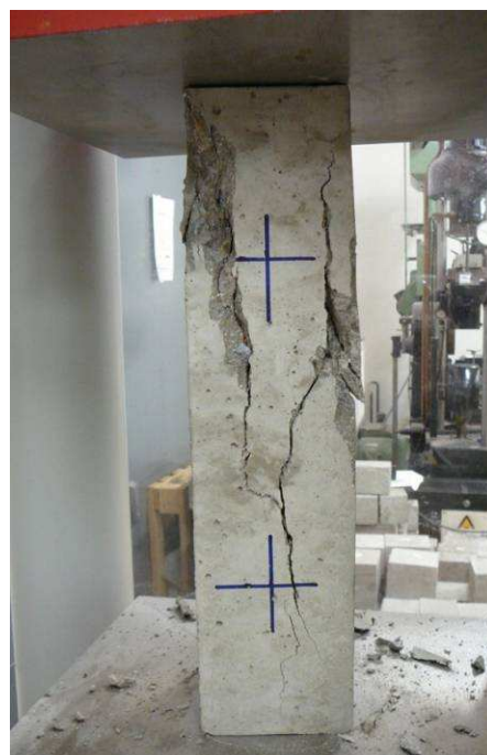
Obr. 6.: Stanovení pevnosti betonu v tlaku – hranol po zkoušce
