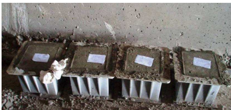
Obr. 7.: Příklad nevhodného uložení těles na stavbě při nízké teplotě
