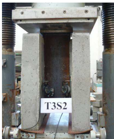
Obr. 3.: Protlačované těleso při zkoušce a měřící aparatura pro prokluz.
