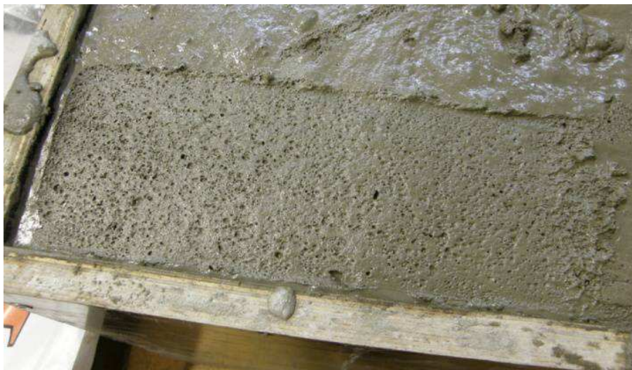
Obr. 2.: Co největší provzdušnění bylo záměrné – detail povrchu kvádrů z provzdušněného betonu po setření zednickou lžící
