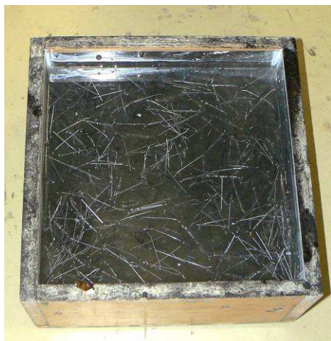
Obr. 6.: Při zalití vzorku se celý objem stal zcela průhledným, v případě potřeby bylo možné provádět dodatečné korekce.
