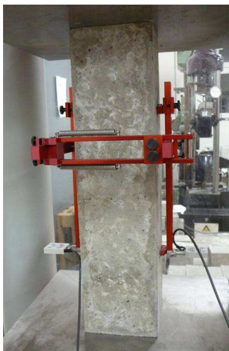
Obr. 5.: Měření statického modulu pružnosti v lisu FormTest
