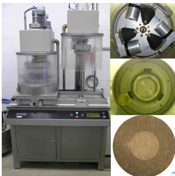
Obr. 7.: Zařízení Wehner/Schulze při ohlazovacím procesu (vpravo ohlazovací kuželíky, měřicí patky a zkušební těleso po zkoušce).
