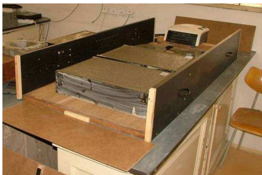
Obr. 3.: Otevřený tunel s pohledem na ventilátor
