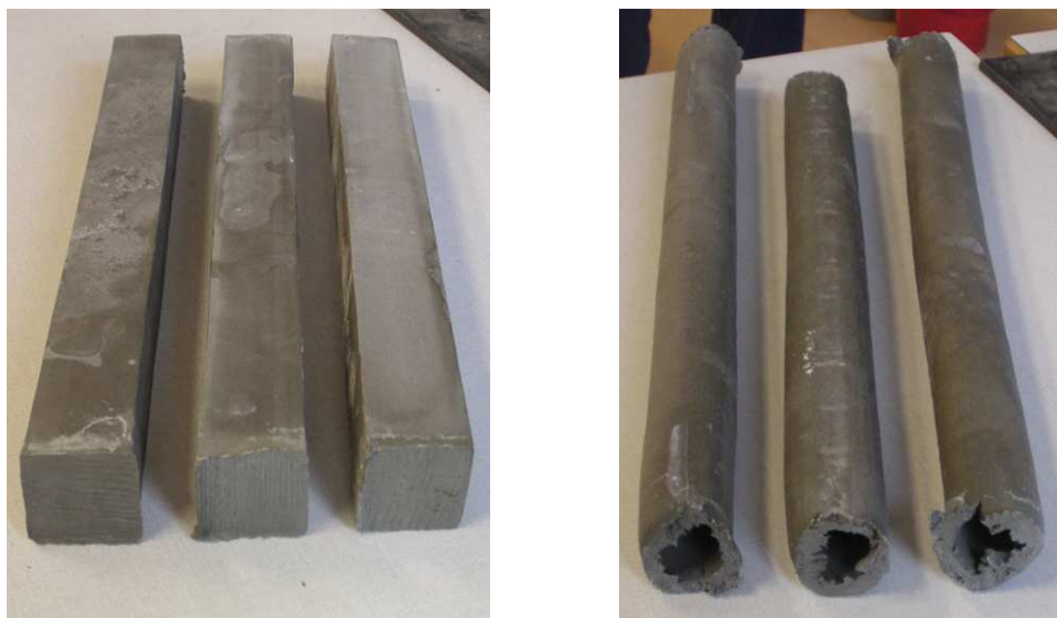
Obr. 1.: Zkušební vzorky extruzí s plným čtvercovým příčným průřezem (vlevo) a dutým kruhovým průřezem (vpravo)
