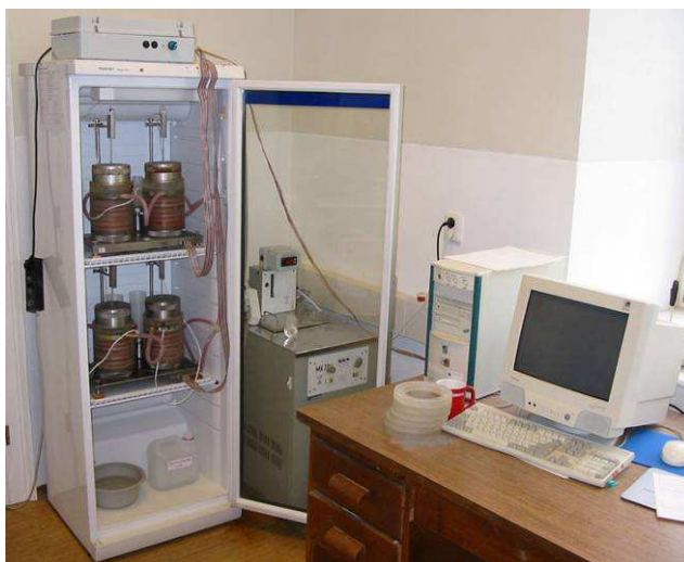
Obr. 10.: zkušební přístroj na funkční zkoušení namrzavosti zemin a materiálů
