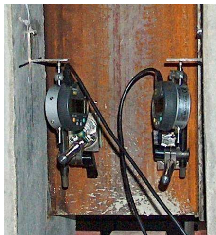
Obr. 3.: Protlačované těleso při zkoušce a měřící aparatura pro prokluz.
