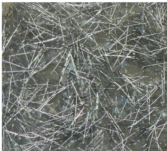
Obr. 7.: Detailní pohled na zatvrdlý vzorek s drátky TRI-TREG v koncentraci 1,5%.
