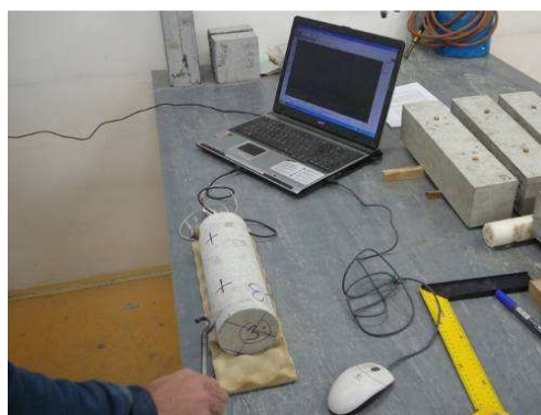
Obr. 7.: Měření modulu pružnosti rezonanční metodou
