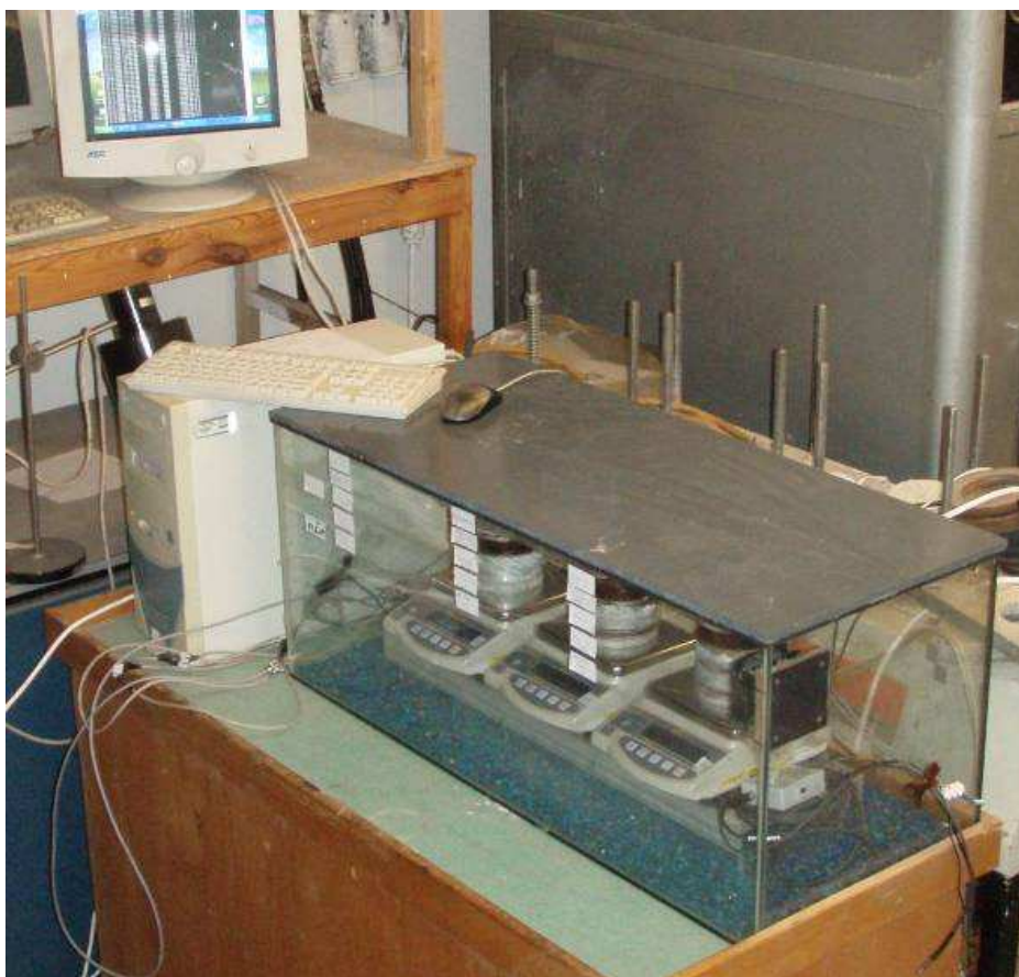
Obr. 1.: Měřicí komora s vloženou sadou tří vzorků, vážícím zařízením a propojením s PC. Vnitřní parametry komory (teplota, relativní vlhkost, barometrický tlak) jsou snímány uvnitř umístěným dataloggerem propojeným s PC.
