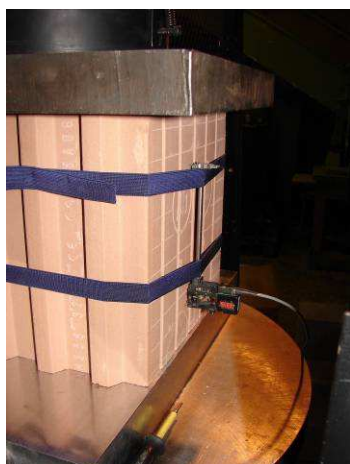
Obr. 9, 10.: Zkouška modulu pružnosti; časový průběh napětí při zkoušce
